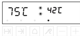
Wenn die aktuelle Kerntemperatur den eingestellten Wert erreicht, schaltet der Backofen ab und in der Anzeige erscheint „End“. Es ertönt ein Signal. Die beiden Leuchten blinken nicht mehr.
