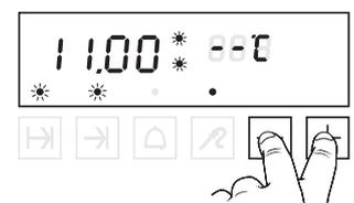
Nach ca. 3 Sek. startet die Schaltuhr, die Leuchten leuchten ständig. Während der Wartezeit bis zum Garbeginn erscheint in der Anzeige „Auto“. In der rechten Anzeige wird Ihnen die aktuelle Kerntemperatur im Innern des Bratens angezeigt.
