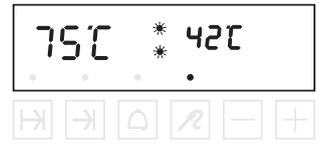
Wenn die aktuelle Kerntemperatur den eingestellten Wert erreicht, schaltet der Backofen ab und in der Anzeige erscheint „End“. Es ertönt ein Signal. Die beiden Leuchten neben der Anzeige blinken nicht mehr.
