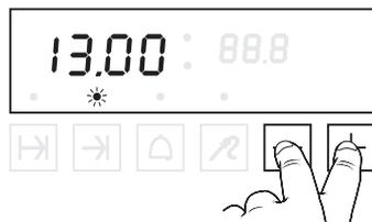
Nach ca. 3 Sek. startet die Schaltuhr, die Leuchte leuchtet ständig. In der Anzeige sehen Sie die Restzeit bis zum Garende. Neben der Anzeige blinken die beiden Leuchten im Wechsel.
