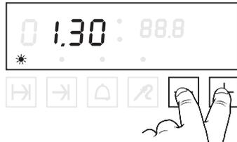
Nach ca. 3 Sek. startet die Schaltuhr, die Leuchte leuchtet ständig. In der Anzeige sehen Sie die Restzeit. Neben der Anzeige blinken die beiden Leuchten im Wechsel.
