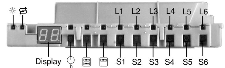
Die Oberkorb – Funktion ist für den gesamten Programmablauf angewählt. Durch Betätigen der Taste S3 kann in den nächsten Programmschritt geschaltet werden, bei überspringen des Heizschrittes, wird dies als Heizfehler angezeigt. ( Ausnahme: Beim Füllschritt weiterschalten nur durch den Füllschalter F1 ). Fehlercodeanzeige ist nur im KD-Prüfprogramm !
