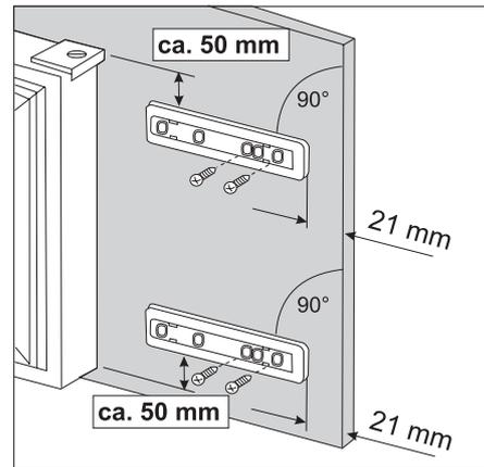
6. Die Schiene auf der Innenseite der Möbeltür oben und unten auflegen (siehe Abb.) und die Position der äußeren Bohrlocher anzeichnen. Nachdem die Löcher gebohrt wurden, die Schiene mit den mitgelieferten Schrauben befestigen.
