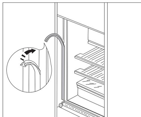
3. Fugenabdeckprofil am Gerät, wie in Abbildung gezeigt ankleben.
