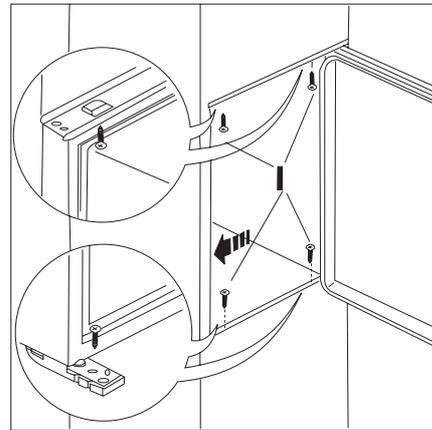
2. Tür öffnen und Gerät gegenüber der Bandseite an die Möbelseitenwand rücken. Gerät mit den 4 beiliegenden Schrauben (I) befestigen.
