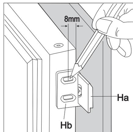
8. Gerätetür und Möbeltür auf ca. 90 ° öffnen. Den Winkel (Hb) in der Schiene (Ha) einsetzen. Gerätetür und Möbeltür zusammenhalten und die Bohrlocher anzeichnen (siehe Abb.).
