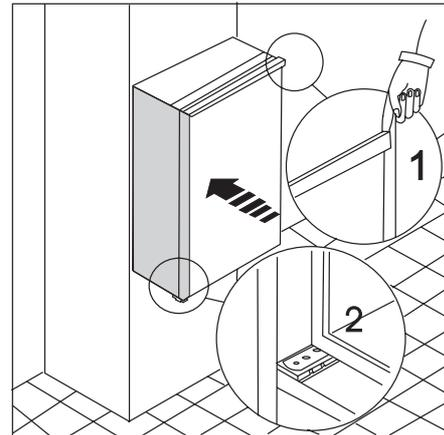
1. Gerät in die Nische einschieben, bis die Anschlagleiste (1) oben am Möbel anliegt und die vordere Kante des Scharniers mit der Türöffnungsseite bündig an der Nischenseitenwand ansteht (2).
