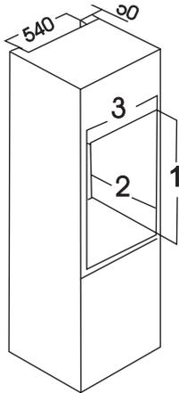
Ferner ist auch am hinteren Einbauschranks ein Lüftungskamin mit folgenden Massen notwendig:
