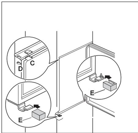
4. Brechen Sie aus der Plastikabdeckung (E), die das Scharnier mit Stift bedeckt, die in der Abbildung gekennzeichneten Teile heraus. Dies wird durch die vorgestanzten Ausbruchlinien erleichtert. "Entfernen Sie das mit DX gekennzeichnete Teil, wenn der Stift am rechten Scharnier angebracht werden soll, andernfalls das mit SX gekennzeichnete Teil."
