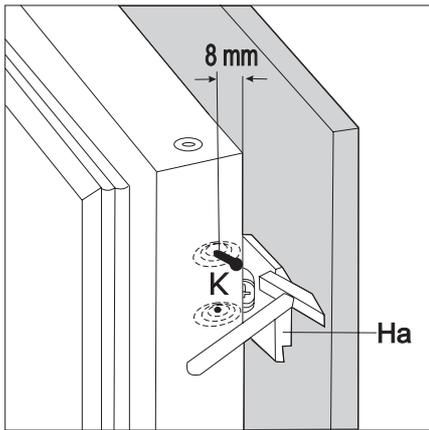
9. Die Winkleisen entfernen und 8 mm vom äusseren Rand der Tür mit dem Nagel (K) kennzeichnen.
