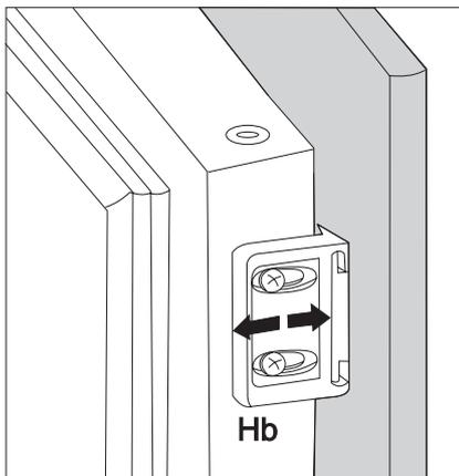
10. Den Winkel wieder auf der Schiene anbringen und mit den mitgelieferten Schrauben befestigen. Für eine allfällig notwendige Ausrichtung der Möbeltür, den Spielraum der Langlöcher nutzen. Nach Beendigung der Arbeiten den einwandfreien Verschluss der Gerätetür überprüfen.
