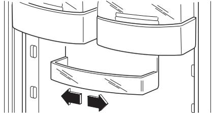
Pour faciliter le nettoyage, il est possible de retirer, puis de remettre en place aisément les balconnets supérieur et inférieur de la contre-porte.
