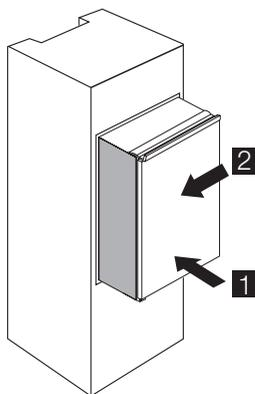
3. Positionnez l'appareil dans le meuble d'encastrement.
