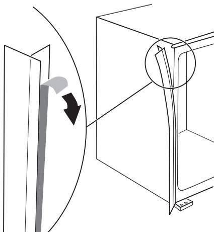
2. Installez l'appareil dans le meuble d'encastrement.
