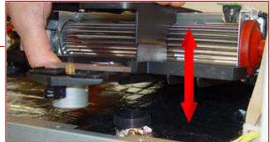
Bei der Montage muss darauf geachtet werden, dass der Schieber vom Dampfsteigrohr und der Klimasensor richtig eingefahren wird, um zu vermeiden, dass ein Dampfleck entstehen kann.
