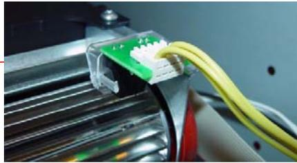
Drehzahl Ventilator Kühlluft (Fotozelle)
