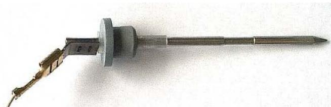
Durch die Kalkbildung zunächst vor allem an der Spitze des Niveausensors sinkt der gemessene Leitwert des Wassers. Bis zu einem maximalen Leitwert wird die Verkalkung toleriert. Bis zur Meldung im Klartextdisplay muss der zulässige Maximalwert eine bestimmte Anzahl Häufigkeit überschritten werden (5 mal oder ca. 200 Std.)
