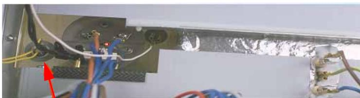
Sensor de compensación de altura y de agua NTC 25°C/100 k $\Omega$
