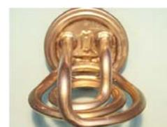
Si la temperatura de la espiral de calefacción supera un valor máximo (parámetro EEPROM), se desconecta la calefacción del calentador para proteger la calefacción (no se emite ningún aviso de error).
