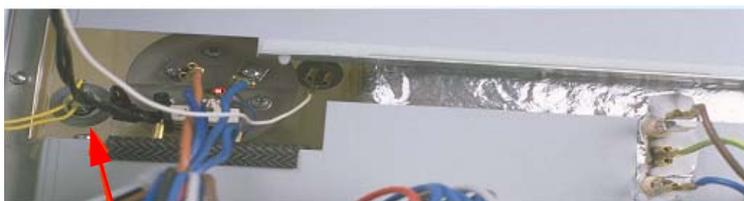
Sensor de compensación de altura y de agua NTC 25°C/100 kΩ
