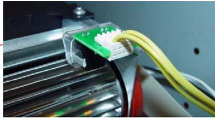
Revoluciones Ventilador aire de refrigeración (fotocélula)
