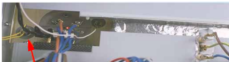
Sensore per compensazione gradi ed acqua NTC 25°C/100 k \Omega
