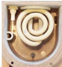
Aquecimento com formação de calcário
