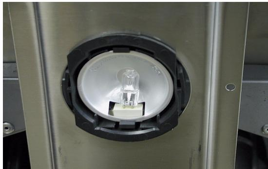
Ziehen Sie die Lampe (B) aus ihrer Halterung heraus. Setzen Sie eine neue Halogenlampe ein, berühren Sie dabei nicht den Glaskolben mit den Händen. Die maximale Leistung der Lampen beträgt 20W. Es wird empfohlen, zum Schutz der Lampe ein trockenes Tuch zu benutzen.
