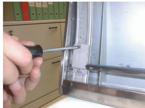
3. Die beiden Schrauben, die die Bedienfeldgruppe am Gehäuse befestigen, entfernen und das Bedienfeld herausnehmen.
