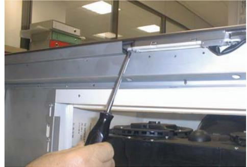
4. Die Schrauben zur Freigabe der Bedienfeldgruppe lösen. Das Bedienfeld öffnen, den Flachdraht lösen und die Steuerplatine herausnehmen.
