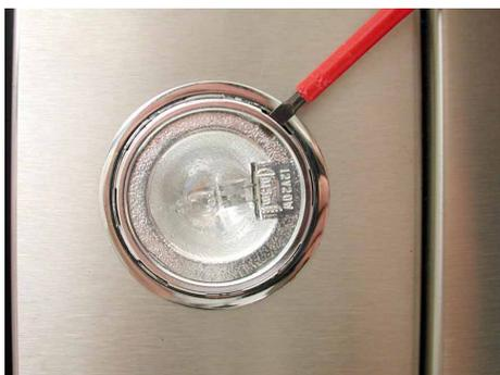
Para recambiar las lámparas halógenas (2x 20 W, tipo G4) hay que desenganchar la cubierta de cristal y sacar las lámparas halógenas del zócalo.
