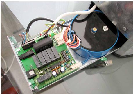
Seguidamente, sacar la electrónica hacia adelante (función de cajón).
