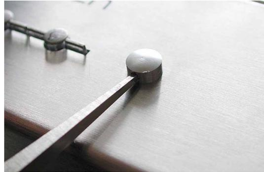
**⚠** ¡Para soltar los tornillos **no se deben emplear** alicates! ¡Existe peligro de que se produzcan arañazos en la carcasa y en los tornillos!
