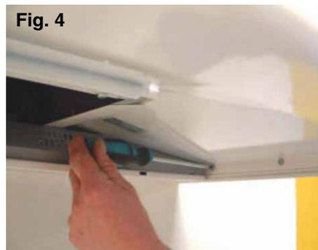
Dévissez les 3 vis du côté gauche et du côté droit de la hotte aspirante (fig. 5).
