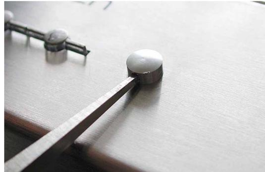
**⚠ Ne pas utiliser** de pince plate pour dévisser les vis! Risque de formation de rayures sur le coffret et la vis!
