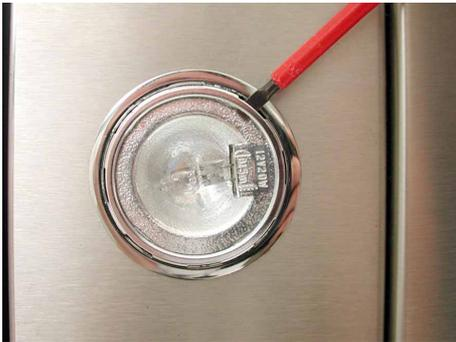
Pour changer les lampes à halogène (2x 20 W, Type G4) retirez le voyant avec un tournevis et retirez la lampe de son socle.
