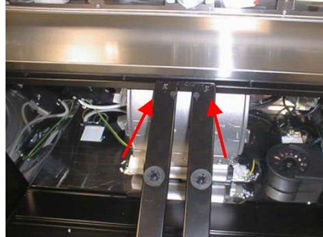
4. Enlever la tôle de fixation avant du filtre en dévissant les six vis maintenant le carter.
