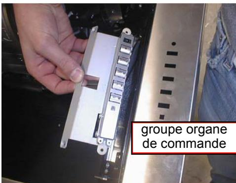
5. Remplacer la platine de commande par une nouvelle platine aux mêmes caractéristiques techniques.
