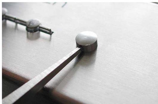
**⚠** Não utilize **nenhum** alicate de pontas chatas para soltar os parafusos! Perigo de formação de riscos na caixa e nos parafusos!
