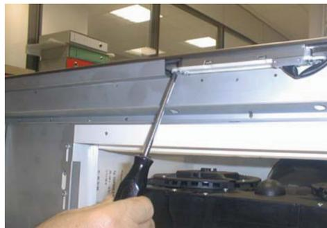
4. Desapertar os parafusos para libertar o grupo do painel de comando. Abrir o painel de comando, soltar o fio plano e retirar a platina de comando.
