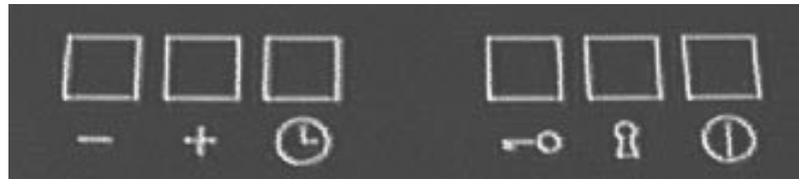
Steuerwabe über Sicherungen spannungsfrei schalten. Die Sicherungen wieder einschalten und innerhalb von **5 Sekunden** den **Schloss-Sensor** betätigen und halten. (*Während dieses Vorgangs wird in den 7 Segmentanzeigen von links nach rechts gelesen der aktuelle Softwarestand angezeigt*).
