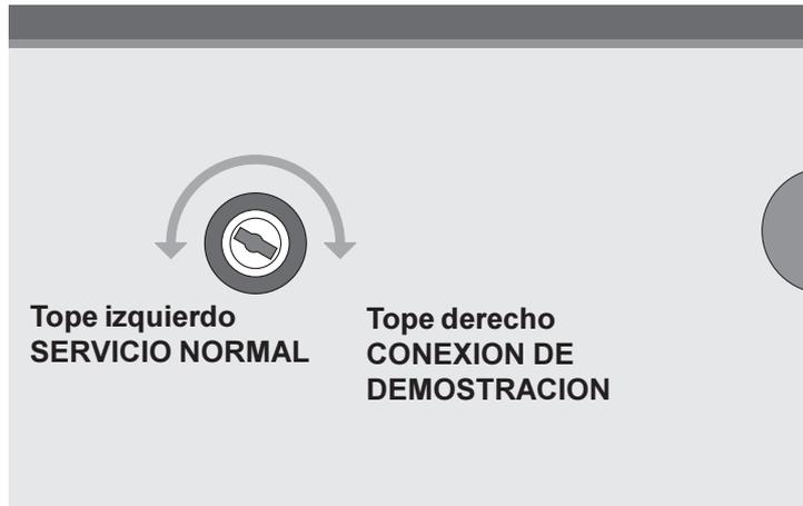
Para activar la conexión de demostración girar el interruptor giratorio que se halla en la cubeta de la encimera *cuidadosamente* hacia la derecha y hasta el tope con un destornillador.
