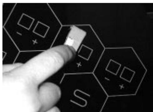
Al final de la operación de regulado hay que probar una vez más todos los sensores con el dedo. El montaje se realiza repitiendo la operación en sentido contrario, tal y como indicamos en las páginas anteriores.
