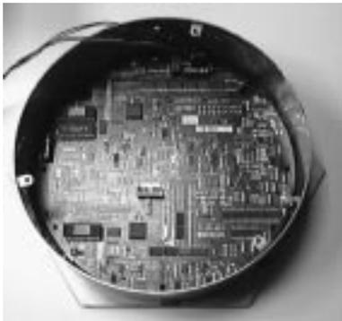
Al desmontar la platina de control se han llevado ya a cabo los pasos de retirar y de aflojar la tapa con la unidad de potencia.
