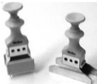
Se a placa de comando estiver com defeito, está disponível - para as versões "pontaguda" e "plana" - uma variante da assistência técnica totalmente equipada. Se esta chegar a ser usada, o eprom secundário e o eprom principal precisam ser removidos da placa de circuito impresso defeituosa com uma ferramenta especial (extractor de circuito integrado) e serem instalados sobre a placa nova.
