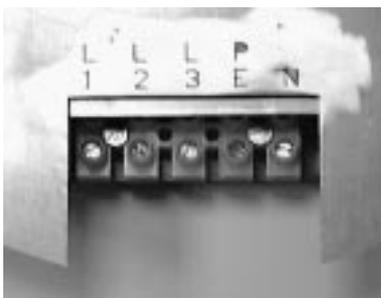
Conexão eléctrica do ESW 308.6
