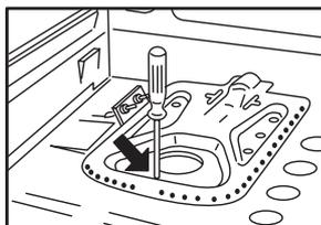
Tirez vers l'avant le brûleur du four (cf. schéma) et déposez-le dans l'intérieur du four, sans le retirer.
