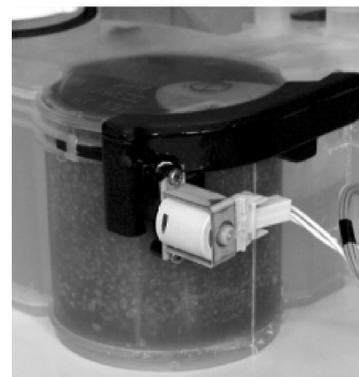
Hinweis: Das Rohwasserventil ist spannungslos geschlossen! -> Rohwasser wird gefüllt!
