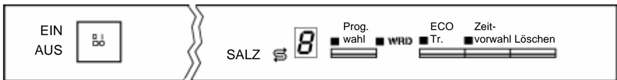
Falls eines der Sicherheitssysteme anspricht, wird dies durch einen Alarmcode in Form eines blinkenden Buchstabens im **ANZEIGE**-Fenster gemeldet.
