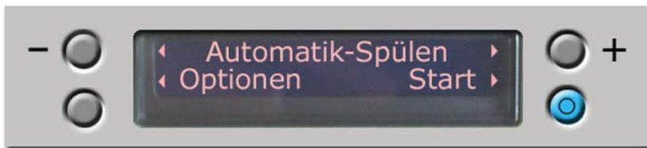
Nach dem Einschalten wird im Startmenü immer das Programm „Automatik-Spülen“ angezeigt.
