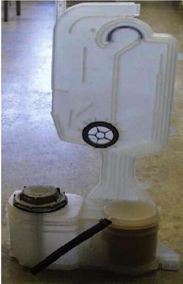
Das Wasserenthärtungssystem besteht aus dem Wasserenthärter und der Regenerierdosierung.
