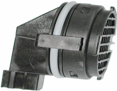
**Wasser-Indikator WI**, wenn ungefähr 1,1 Liter Wasser in dem Sumpf sind, drückt eine Membrane auf einen mechanischen Schalter. Der Schalter meldet der Elektronik, ob sich Wasser im Behälter befindet oder nicht.
