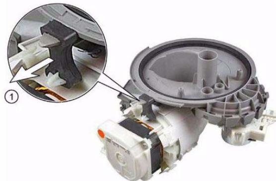
2. Schlauchschelle an der Verbindung zur Wasserweiche mit einem Seitenschneider lösen.
