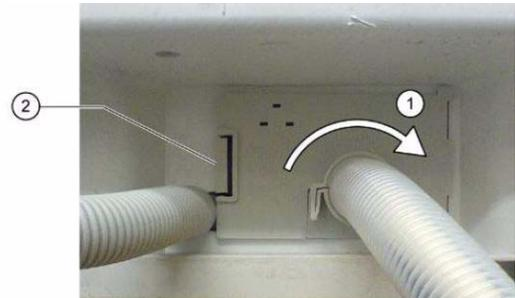
3. Ablaufschlauch nach hinten aus Halterung drücken
