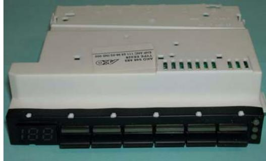
Die elektronische Steuerung EDW1500 besteht aus einer elektronischen Hauptelektronik und einer Steuer-/Anzeigeelektronik, die in einem gemeinsamen Kunststoffbehälter integriert sind.
