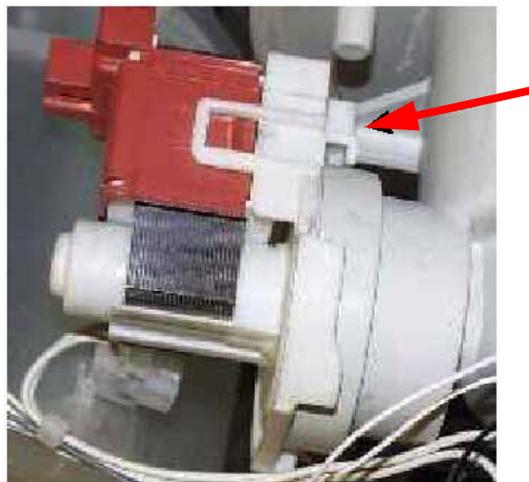
Zum Entfernen des Pumpenmotors zuerst die Verriegelung an der Oberseite des Motors anheben und dann den Motor entgegen des Uhrzeigersinns (Sockelseite) drehen.
