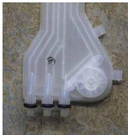
Die Messung erfolgt durch elektrische Impulse, die von dem integrierten Reedschalter zu dem Kontrollboard abgegeben werden (208 Impulse = 1 Liter Wasser). Das Kontrollboard zählt die Impulse. In dem EE-PROM des Kontrollboards ist die Anzahl der notwendigen Impulse für die verschiedenen Programmabläufe gespeichert.
