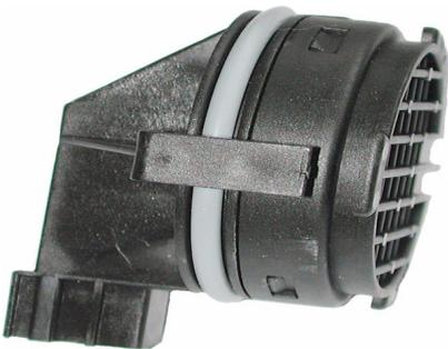
**Indicador de agua WI**, cuando hay aprox. 1,1 litros de agua en el sumidero, una membrana aprieta en un interruptor mecánico. El interruptor avisa a la electrónica de si hay agua en el depósito o no.
