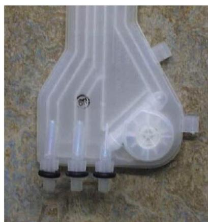
La medición tiene lugar por medio de impulsos eléctricos que el interruptor de lengüeta integrado transmite al tablero electrónico (208 impulsos = 1 litro de agua). El tablero electrónico cuenta los impulsos. En el EE-PROM de la electrónica de control está guardado el número de los impulsos necesarios para las diversas secuencias de programa.
