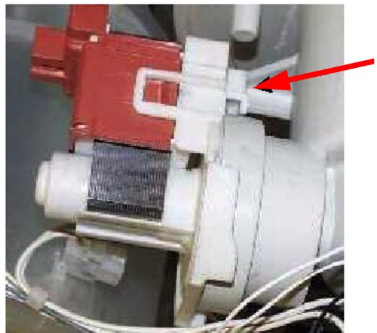
Para retirar el motor de la bomba primero hay que levantar el bloqueo en la parte superior del motor y girar entonces el motor en el sentido contrario al de las agujas del reloj (lado del zócalo).
