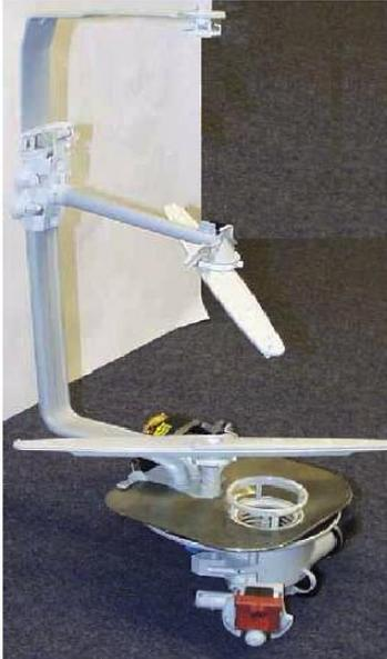
El suministro de agua al brazo aspersor superior y a la ducha de techo se lleva a cabo a través de un tubo de plástico doble que se encuentra dentro del depósito.
