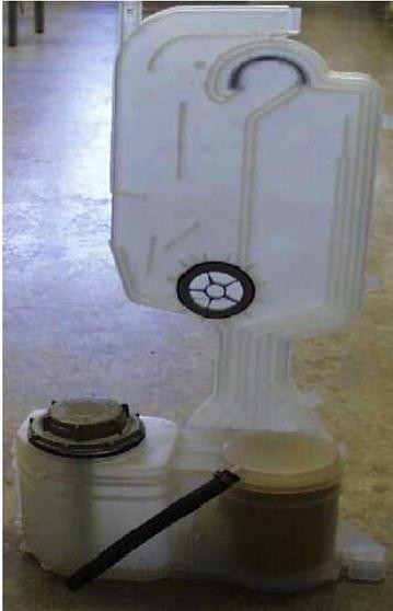
El sistema de desendurecimiento o descalcificación de agua se compone del desendurecedor de agua y de la dosificación de regeneración.
