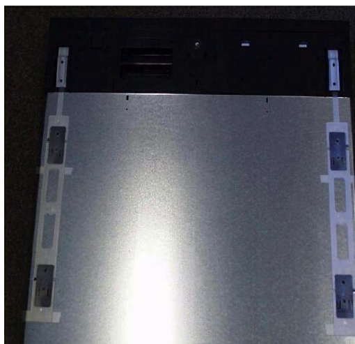
Eléments de fixation de la porte en bois sur la porte extérieure
