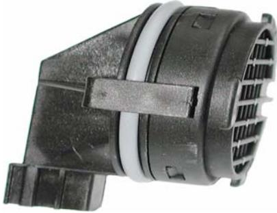
Quand environ 1,1 litre d'eau se trouve dans le réservoir en charge, l'**indicateur d'eau** appuie sur une membrane placée sur l'interrupteur mécanique. L'interrupteur indique à l'électronique si de l'eau se trouve dans la cuve ou non.
