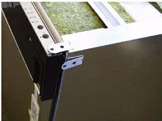
La fixation du lave-vaisselle s'effectue à l'aide de deux languettes, soit directement sur le plan de travail, soit sur l'armoire attenante.
