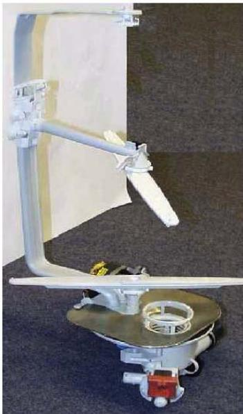
L'amenée en eau vers le bras d'aspersion supérieur et la douchette de plafond s'effectue par une conduite d'alimentation double en plastique montée à l'intérieur de la cuve.
