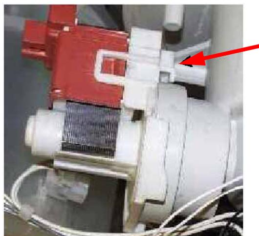
Pour retirer le moteur de pompe, soulever d'abord le verrouillage sur le côté supérieur du moteur et tourner ensuite le moteur dans le sens inverse des aiguilles d'une montre (côté socle).
