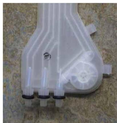
La mesure s'effectue par des impulsions électriques données de par l'interrupteur Reed au panneau de contrôle (208 impulsions = 1 litre d'eau). Le panneau de contrôle compte les impulsions. Le nombre des impulsions nécessaires pour les différents déroulements de programmes est enregistré dans le EE-PROM du panneau de contrôle.
