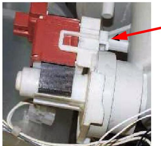
Per estrarre il motore della pompa, sollevare innanzitutto il dispositivo di bloccaggio posto sul suo lato superiore e ruotare quindi il motore in senso antiorario (dalla parte dello zoccolo).
