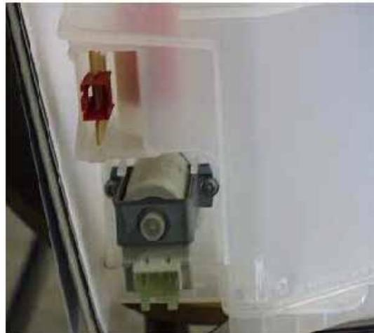
**Decalcificatore con dispositivo di dosaggio di rigenerazione.**
