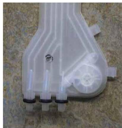
L'acqua è misurata tramite impulsi elettrici, che vengono poi inviati dall'interruttore Reed al pannello di comando (208 impulsi = 1 litro d'acqua) dove vengono contati. Il numero di impulsi necessari ai diversi cicli di programma è memorizzato nell'EE PROM.
