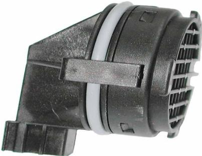
**L'indicatore WI** spinge una membrana contro un interruttore metallico quando ci sono circa 1,1 litri d'acqua nel fondo. L'interruttore segnala all'elettronica la presenza o meno d'acqua nel serbatoio.
