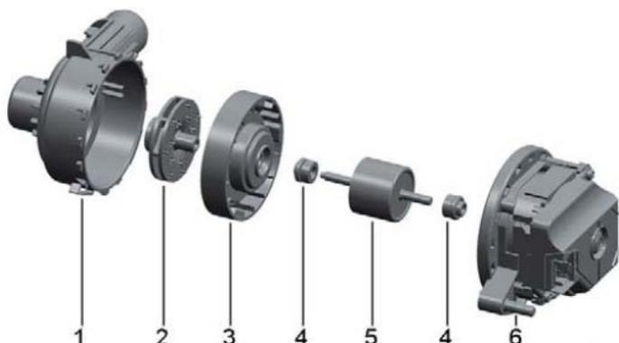
O motor não tem qualquer protecção térmica do enrolamento, dado que a electrónica do motor detecta automaticamente estados de perturbação e sobrecargas e desliga o motor.
