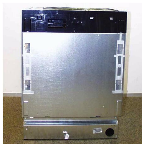
Elementos de fixação da porta de madeira na porta exterior
