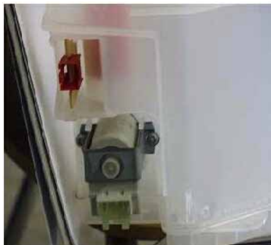
Descalcificador de água com doseamento de regeneração.
