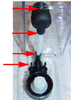
2. Anschließend überprüfen Sie, ob der Schlauch ausgehängt oder abgerissen ist.
