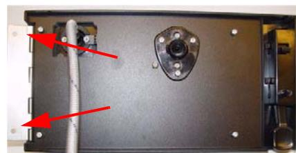
2. Lösen Sie die Schrauben und entfernen Sie das Türinnenblech.
