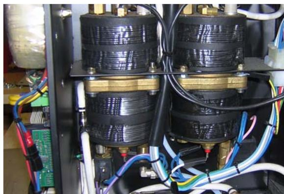
Le niveau d'eau n'est mesuré que dans le chauffe-eau destiné à la production de vapeur et ce, via un capteur exploitant la conductivité de l'eau, et évalué via l'électronique qui mesure le changement de résistance.
