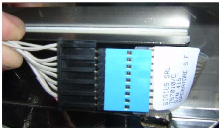
**⚠ Veillez à un raccordement propre entre le panneau des touches et le microprocesseur !**
