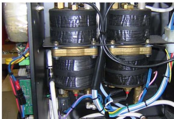
O nível de água só é medido no termoacumulador de vapor, nomeadamente através de uma sonda que aproveita a condutibilidade da água e é avaliada através da alteração da resistência da electrónica.
