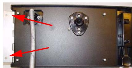
2. Solte os parafusos e retire a placa interior da porta.
