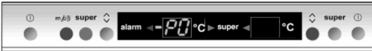
Durch Drücken der KF-Temperatureinstelltaste wird der im Prüfprogramm vorwärts gesprungen, mit der Alarm-Aus Taste rückwärts. Die GF-Super Taste aktiviert den Prüfschritt. Wird die Taste länger als 12 Sek. betätigt, wird die Prüfung von Verbrauchern abgebrochen. Wird 5Min. lang keine Taste betätigt geht das Gerät zurück in den Regelbetrieb. Durch Ausschalten des Gerätes wird ebenfalls das Prüfprogramm verlassen.
