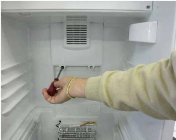
1. Die beiden Befestigungsschrauben des Ventilator-Gehäuses lösen und das Gehäuse nach unten herausziehen.
