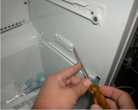
3. Einen Schraubenzieher mit flacher Kante verwenden und das Schutzgitter des 0°-Fühlers abnehmen
