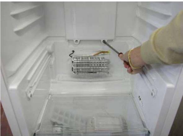
1. Die beiden Befestigungsschrauben des Kanals (oder Filterkanals, wenn vorhanden) lösen; zum Herausnehmen den Kanal nach unten ziehen.
