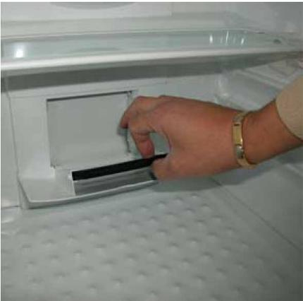
Die Klappe öffnen und den Kohlefilter mindestens einmal jährlich auswechseln.
