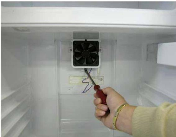
1. Den Kühlraum-Fühler von der Halterung nehmen und die 3 Befestigungsschrauben des Ventilators lösen.
