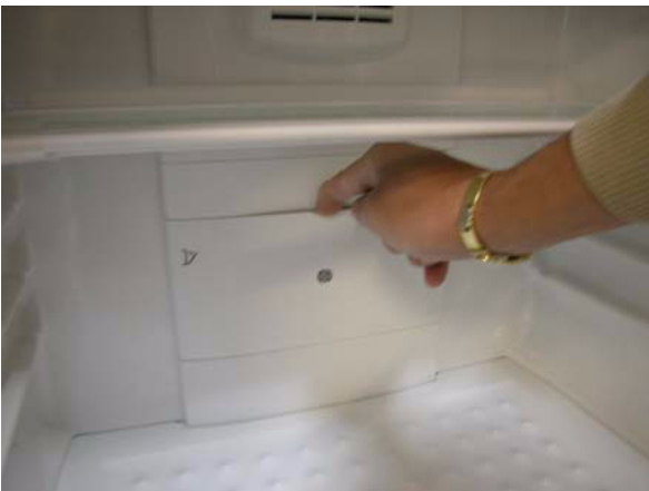
3. Die Klappe öffnen und den Kohlefilter mindestens einmal jährlich auswechseln.
