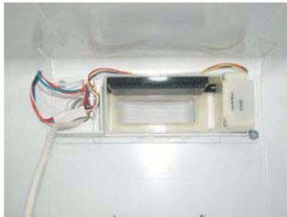
6. Der Dampfer ist mit 2 Schrauben befestigt und ist mit der elektrischen Verdrahtung durch einen 4-poligen Verbinder verbunden
