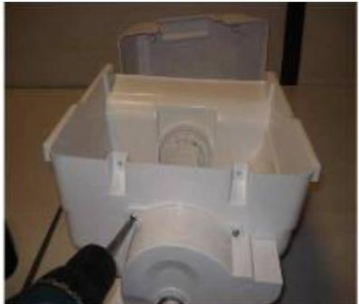
3. Anschließend ziehen Sie die beiden Ringe am Verbindungsteil, das die Welle mit dem Eiszerkleinerer verbindet, mit einem Schraubendreher heraus.
