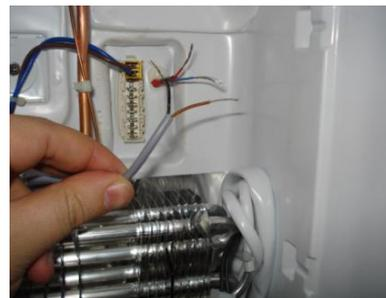
3. Verbinden Sie den neuen Sensor und Kabel.
