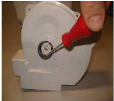
4. Nun ziehen Sie den in den Eiszerkleinerer ragenden Arm aus seiner Halterung und trennen ihn vom Gehäuse. Dies entspricht den Einbauschritten in umgekehrter Reihenfolge.
