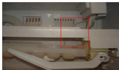
Kabel darf nicht eingeklemmt werden
