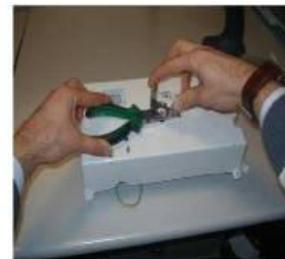
Nun verbleiben lediglich die Steckerverbindungen zwischen Motor und Elektromagnet und zum Erdungskabel. Nachdem diese gelöst wurden, wird auch der Eiszerkleinerungskolben zu Wartungszwecken entnommen. Der Einbau des Eisbereitermotors erfolgt in umgekehrter Reihenfolge.
