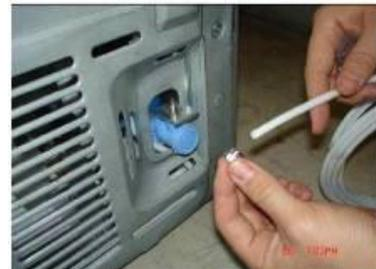
Bei der Wasserzuführung über die Wasserleitung wird keine Pumpe benötigt. Der Anschluss erfolgt über ein passendes Adapterstück an die Wasserleitung. Das Ende des Schlauches wird über ein Adapterstück an das Wasserventil angeschlossen, der Wasserhahn anschließend geöffnet.
