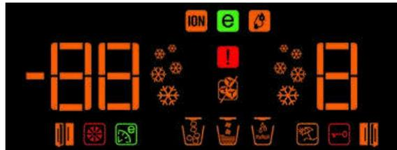
Der Kühlbereich arbeitet gemäß den Schnellkühlen-Schwellwerten. Nach Ablauf von 2 Stunden wird das Schnellkühlen beendet. Die Schnellkühlen-Symbole (LEDs) erlöschen, das Gerät arbeitet wieder mit den zuvor eingestellten Werten. Falls die Schnellkühlen-Taste bei bereits aktiver Schnellkühlen-Funktion erneut betätigt wird, erlöschen die Schnellkühlen-Symbole, das Gerät arbeitet wieder mit den zuvor eingestellten Werten.
