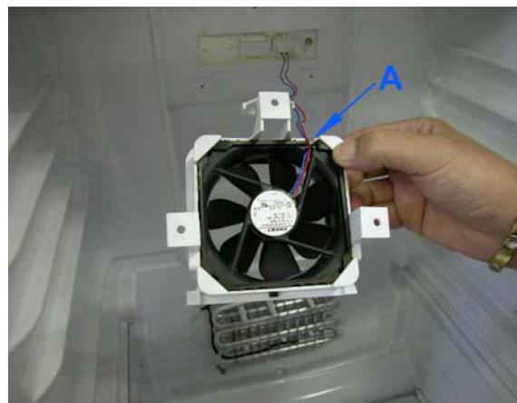
2. Los cables del ventilador tienen que tenderse a través de la ranura (A) del soporte del ventilador.
