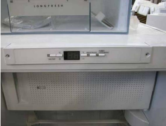
1. Retirar las dos cubiertas de los tornillos
