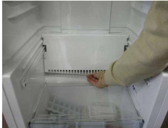
4. Soltar los dos tornillos de la cubierta del evaporador.
