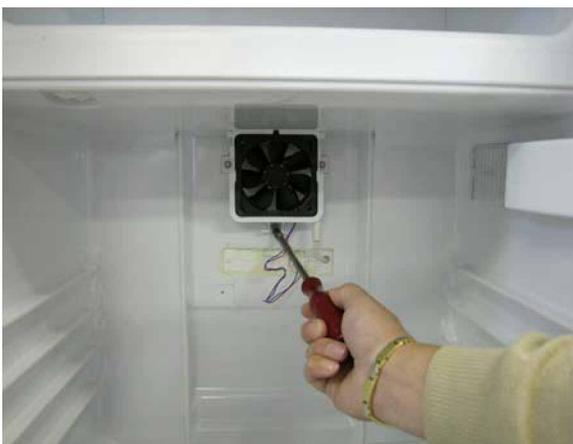
1. Quitar el sensor del compartimento refrigerador del soporte y soltar los 3 tornillos de fijación del ventilador.
