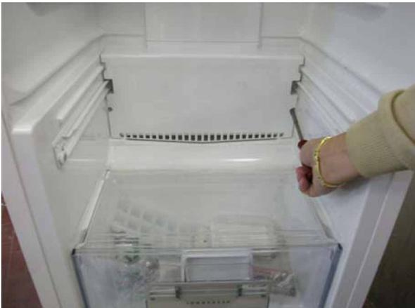
4. Soltar los dos tornillos de la cubierta del evaporador.
