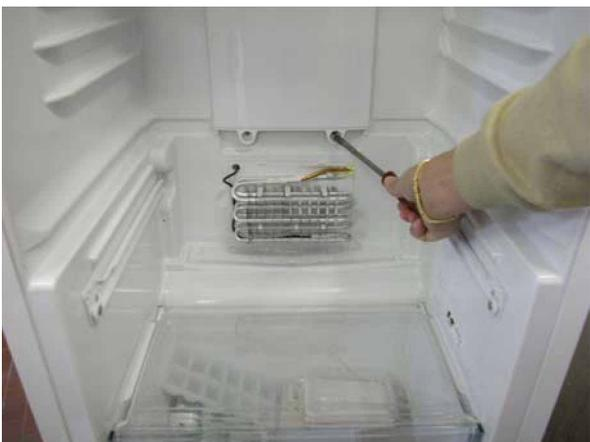
1. Soltar los dos tornillos de fijación del canal (o del canal del filtro, si lo hubiera); para sacar el canal hay que tirar hacia abajo.
