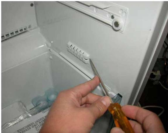
3. Emplear un destornillador con borde plano y retirar la rejilla protectora del sensor de 0°
