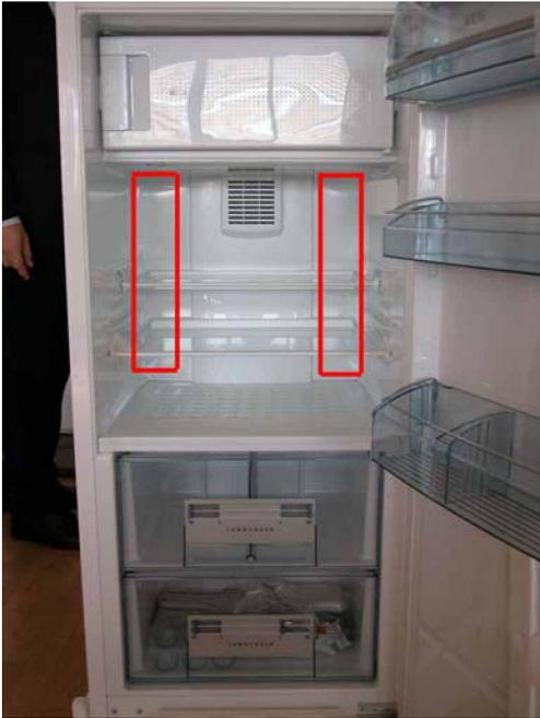
a Vista interior del compartimento refrigerador (posición aproximada de los elementos de calefacción de compensación)
