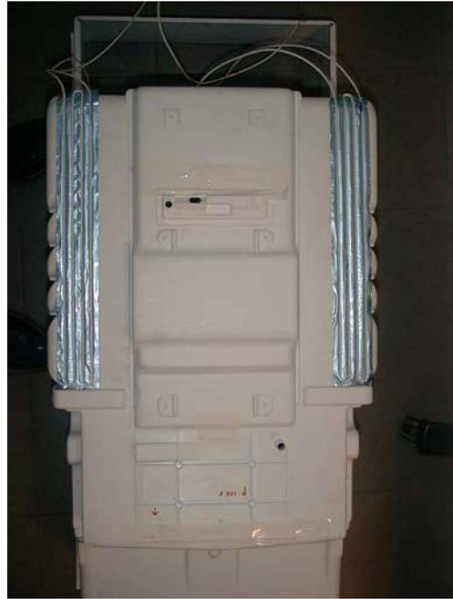
b Vista trasera del compartimento refrigerador (antes del espumado de la carcasa)
